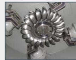
Dans la turbine Pelton, la conversion de l'énergie de pression de l'eau en énergie cinétique s'effectue entièrement dans le distributeur. Étant donné que le différentiel de pression total disparaît seulement dans la buse, la pression à l'intérieur du rotor reste constante. Pour réguler la puissance de la turbine, on ajuste la section de la buse.
