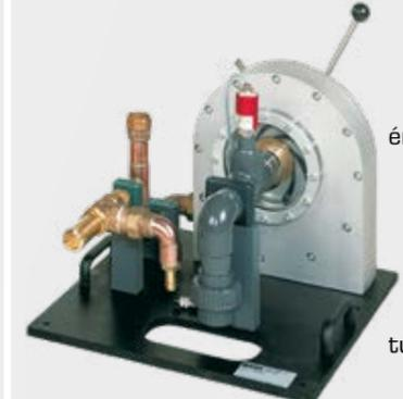
Dans la turbine Francis, la conversion de l'énergie de pression de l'eau en énergie cinétique s'effectue dans le distributeur et dans le rotor. La pression à l'entrée du rotor est supérieure à la pression à la sortie du rotor. Pour réguler la puissance de la turbine, on ajuste les aubes directrices.
